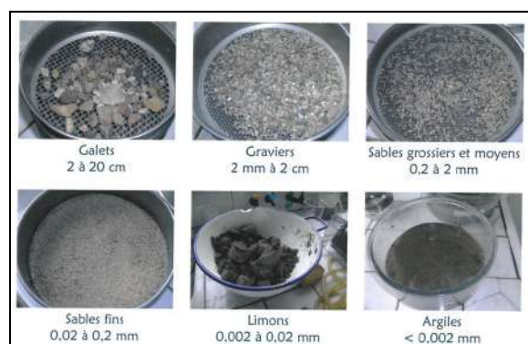
Classes granulométriques, tamisage effectué au laboratoire de Géographie physique (© CNRS UMR 8591) - S.Grivel
