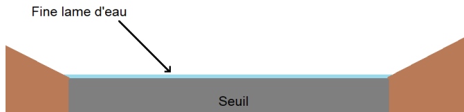
Schéma de la lame d'eau en période d'étiage sur un seuil linéaire et plan.
